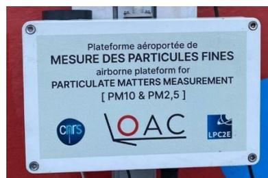
Depuis 2013, le Ballon Generali de Paris mesure en permanence les particules fines présentes dans l'air ambiant : Cette performance est réalisée grâce au **LOAC** (Light Optical Aerosol Counter), capteur embarqué à bord du ballon. Cet appareil, développé par le laboratoire de physique et chimie de l'environnement et de l'espace ( LPC2E - CNRS/UNIVERSITÉ ORLÉANS :CNES), est le premier capable d'étudier, 24h/24, depuis le
